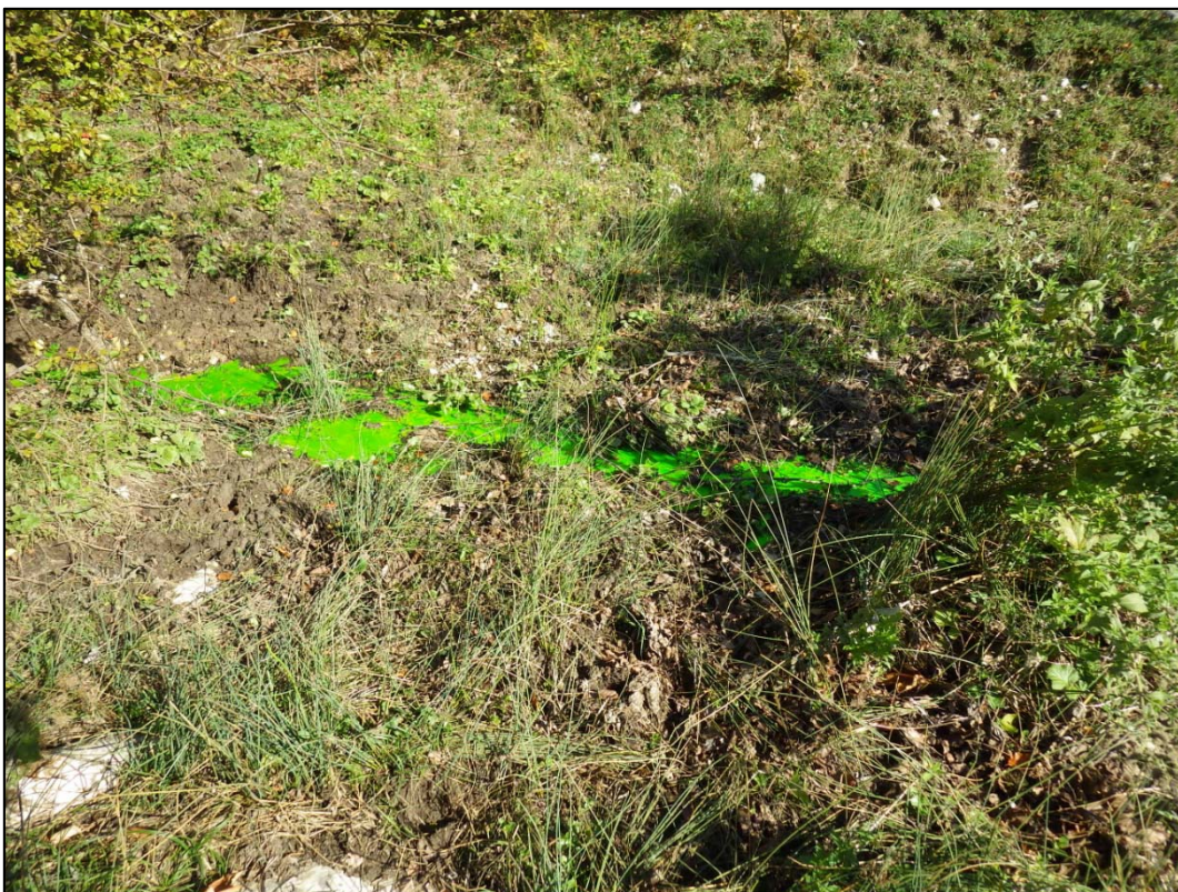
Injection fluorescéine combe Marin
