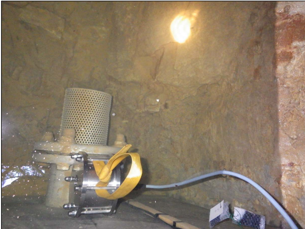
Fluorimètre Source des Vuires – « Faille »
